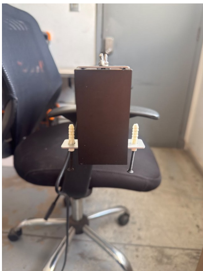
Tornillos con tarugos instalados en los orificios del soporte.
